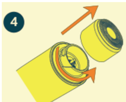
Giro en sentido antihorario para retirar el cabezal rotatorio.
